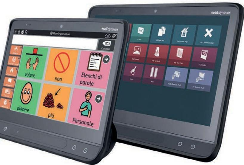
Il **sistema di tracciamento** (eye tracker) contenuto nello strumento, consente di attivare con lo sguardo elementi sullo schermo di piccolissime dimensioni.
